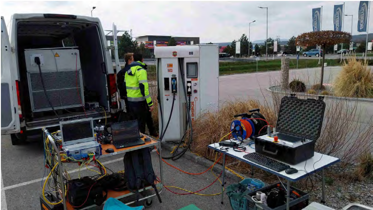
Abb. 1. Beispielhafter Messaufbau während eines Feldtests mit dem Prüfgerätedemonstrator (links im Bild im Transporter) sowie dessen externer Bedieneinheit (Koffer, rechts im Bild), einer DC-Ladestation (50 kW, Bildmitte) und ergänzender Messtechnik
